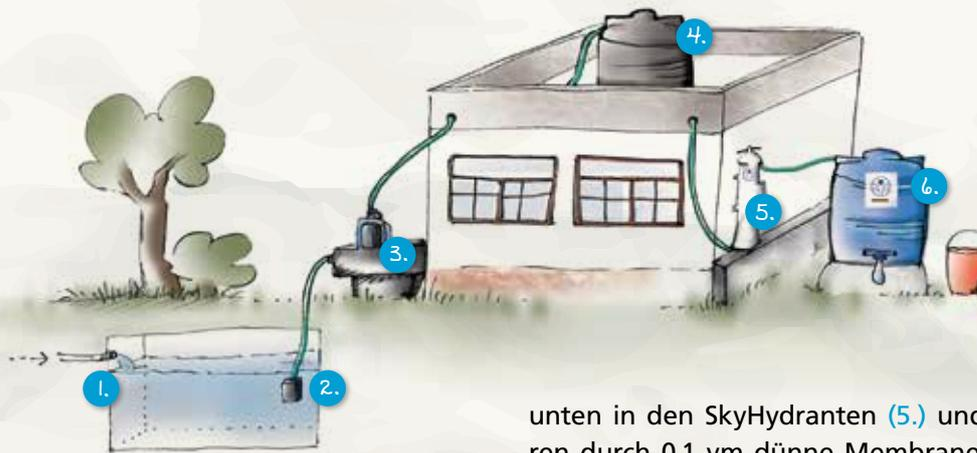
Das u.a. mit Bakterien verseuchte Wasser wird aus dem unterirdischen Wasserspeicher des Krankenhauses (1.) mithilfe einer elektrischen Pumpe (3.) auf das Dach gepumpt. Dort steht das verunreinigte Wasser in einem 1.000 Liter Tank (4.) bereit für die Filterung. Diese geschieht ganz ohne Chlor und elektrische Energie, sondern nur mithilfe der Höhenenergie des Wassers. Dabei gelangt das Wasser von
